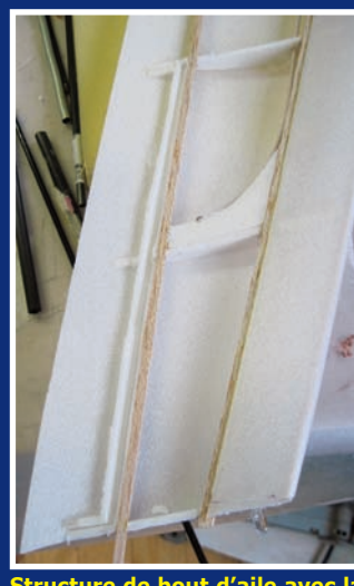
Structure de bout d'aile avec la diode en attente.
