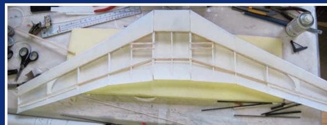
La structure de l'aile après coffrage du dessus.
