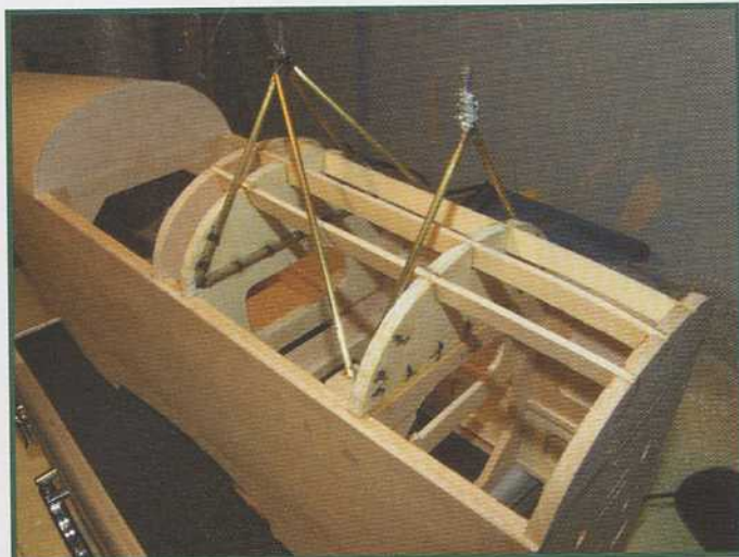
L'avant du fuselage en construction. Noter que la platine de fixation d'aile a finalement été reculée (c'est corrigé sur le plan).
