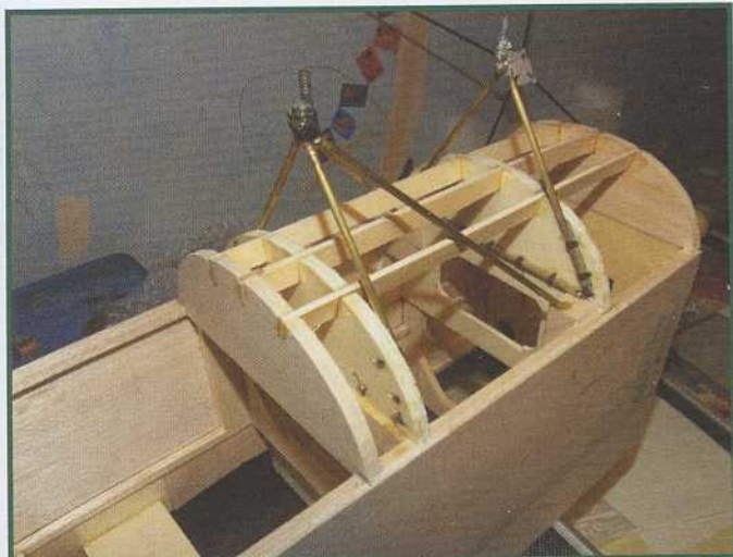
L'avant du fuselage en construction. Noter que la platine de fixation d'aile a finalement été reculée (c'est corrigé sur le plan).
