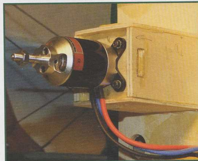
Le moteur (XPower 3526/10, Topmodel) en place sur son bâti.
