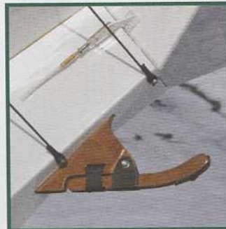
La béquille est efficacement amortie.
