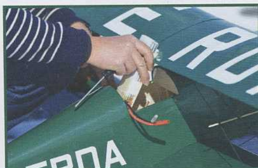
L'accu est engagé vers l'arrière avant d'être glissé à l'avant. La fixation sur la platine solide du fuselage se fait par trois vis.
