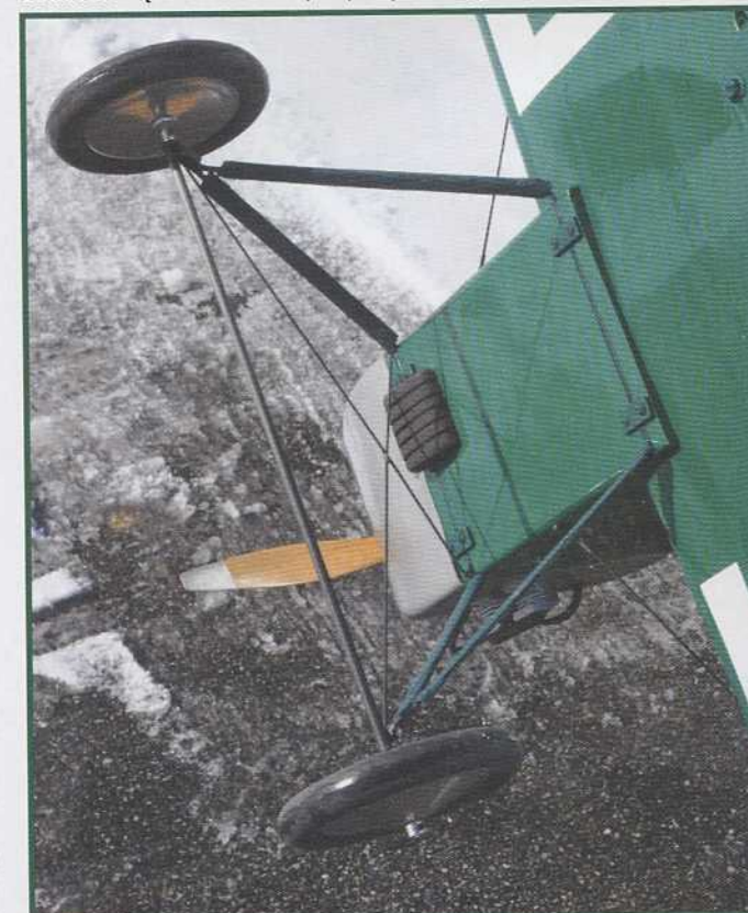
Vue générale du train. L'axe de roue, factice, est constitué d'un tube carbone.
