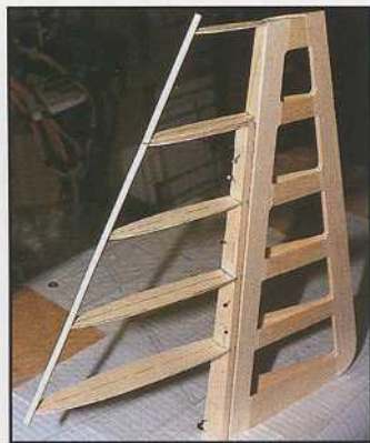
La dérive avant coffrage de la partie fixe.
