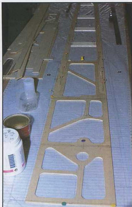
Un flanc de fuselage découpé, à la mode des kits Godfrey bien connus ils y a quelques années.
