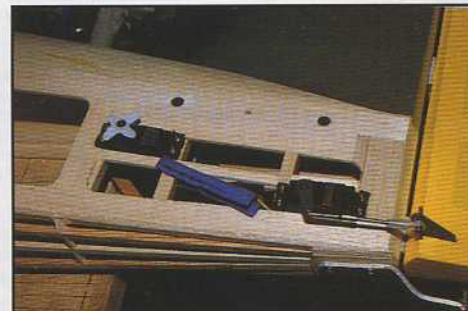
Les supports de servos sont renforcés à l'arrière du fuselage.
