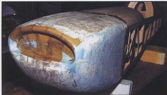
Le capot moteur est réalisé en fibre sur un moule perdu.
