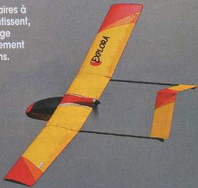
Dépourvu de tout système de décollage et d'atterrissage, l'Explora doit être lancé à la main
