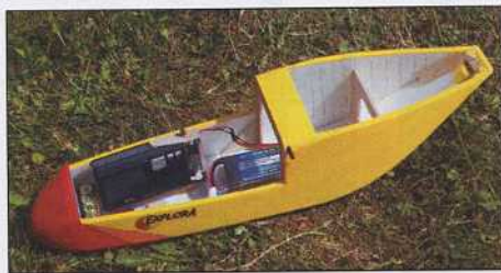
Voici la caisse avant du fuselage qui porte l'appareil photo numérique (ou autre) et le pack de propulsion 3S1300 : sa forme traduit son aspect utilitaire.
