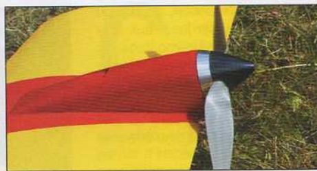
Le moteur Typhoon 15/10 est monté en pylône sur le tronçon central des ailes. Il agit en mode propulsif, entraînant une hélice APC-E 8 x 6.
