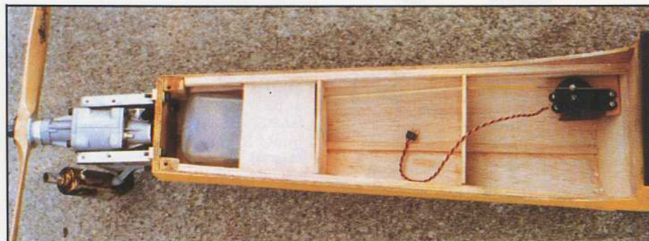
Toute la radio est dans l'aile ; une plaque de c.t.p. vient recouvrir la batterie, le récepteur et l'interrupteur ; seul le servo des gaz est dans le fuselage.
