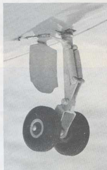
Le plan fixe, en Té, est démontable ; le diabololo avant est suspendu.
