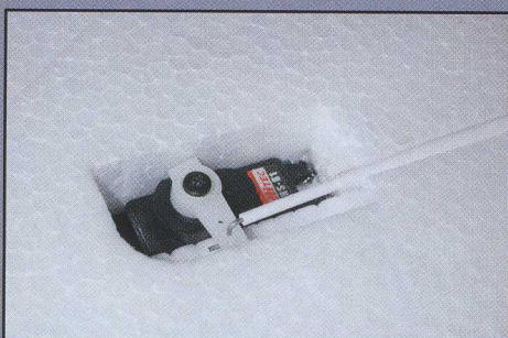
Les servos sont parfaitement à l'abri dans leurs logements.
