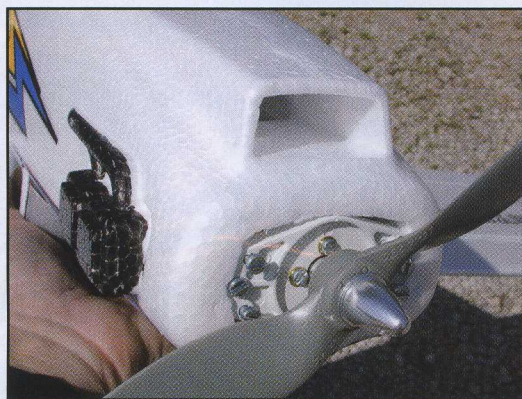
Une entrée d'air généreuse est située sous l'hélice. Notez que les réglages du calage moteur sont facilement accessibles.
