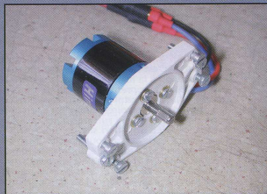
Le moteur sur son support qui permet de régler piqueur et anticouple.
