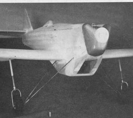
Le capot avant, est en cours d'ajustage, et le conduit amenant l'air au radiateur n'a pas encore ses déflecteurs.
