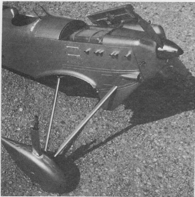
Sous le capot AV supérieur, trouvez place le réservoir. Pour renforcer le réalisme de la maquette quelques pipes d'échappement et bandes de rivets seront les bienvenus. Mais attention, il ne faut pas les disposer n'importe où ! Par rapport à cette photo, le plan a été modifié pour une meilleure accessibilité.
