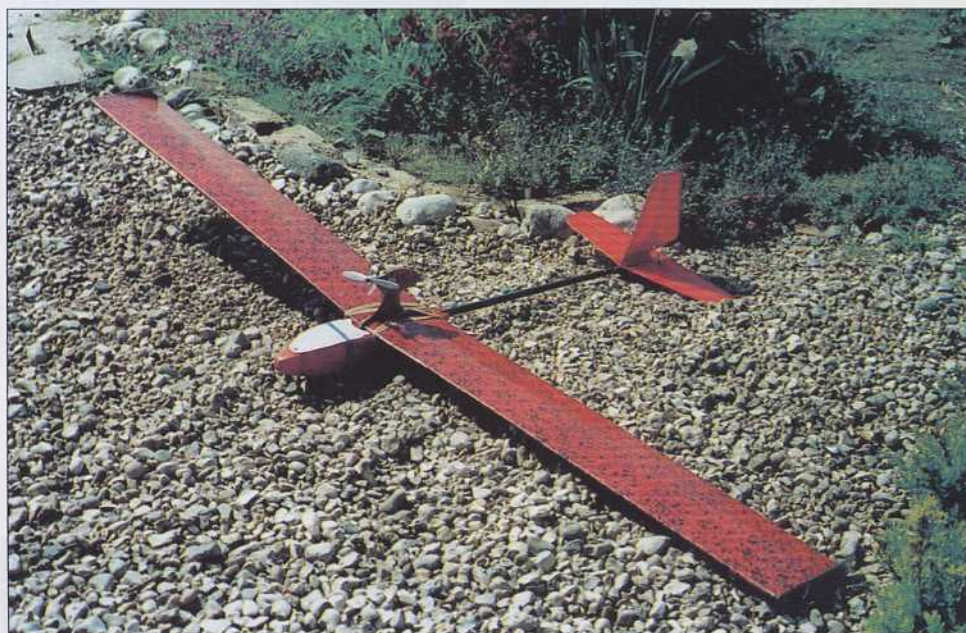
▲ Ce planeur (moto et pente) fut entièrement réalisé selon les méthodes décrites dans cet article. Cellule: Dépron 6 mm coffré koto thermocollant; Ailes: Dépron 3 mm galbé, finition « papier-cadeau » enduit et vernis. Empennage: Dépron 3 mm renforcé balsa finition « papier cadeau » enduit et verni. Constatez le résultat...
