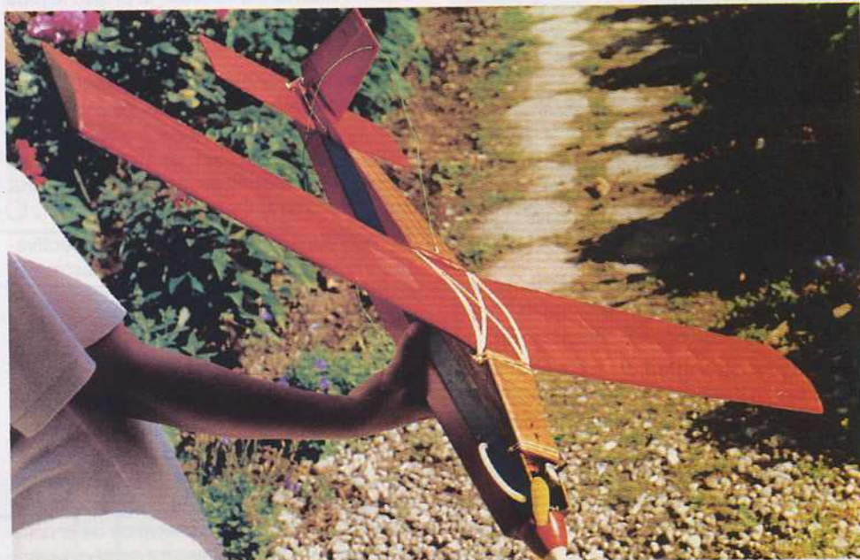
▲ On distingue bien les types de matériaux qui revêtent l'Alcyon : PVC rouge et bleu puis acajou. On remarque à l'avant la vidange des huiles brûlées du moteur PAW.
