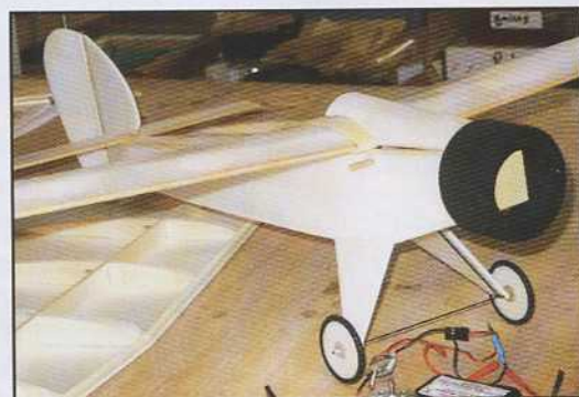
Le Micro Baron 2 axes avec un seul renfort en baguette 3 x 3.
