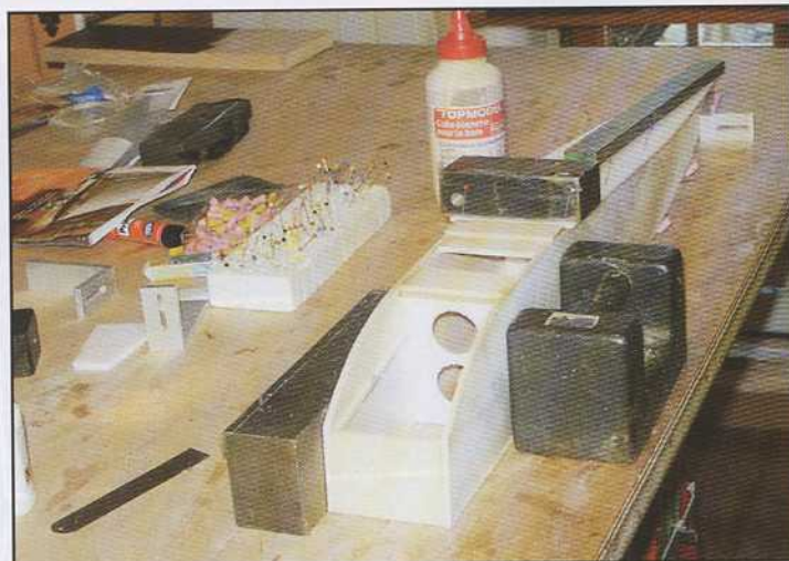
L'avant du Daddy est renforcé, à la fois par du Dépron de 3 mm, du balsa 10/10 et des baguettes 3 x 3.
