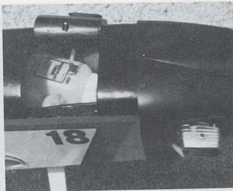
Le compartiment réservoir peut accueillir un modèle de 250 cm 3 , mais une telle capacité n'est pas indispensable pour un 4-temps qui, en général, consomme beaucoup moins. J'emploie un 160 cm 3 qui autorise 25 à 30 mn de vol.
