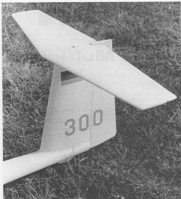
Détail des empennages : stabilo à volet et dérive encastrée.
