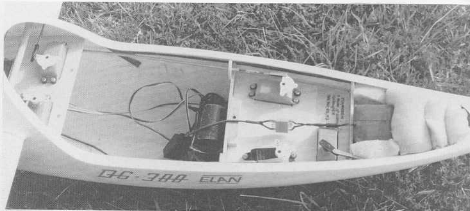
L'installation radio : batterie 1,2 Ah, servo de remorquage, servos de profondeur et direction, récepteur, servos d'ailerons et d'aérofreins. Le train rentrant arrive !
