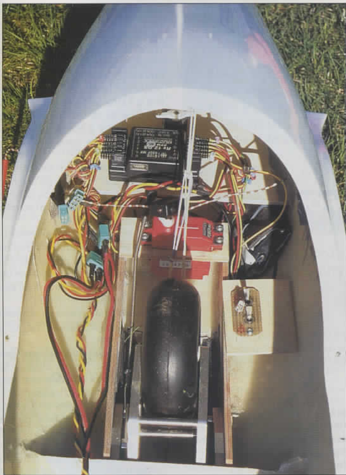
Outre les servos logés dans les ailes et la dérive, le gros du radio se trouve au centre du fuselage, derrière le train rentrant (en option). C'est pas la place qui manque.
