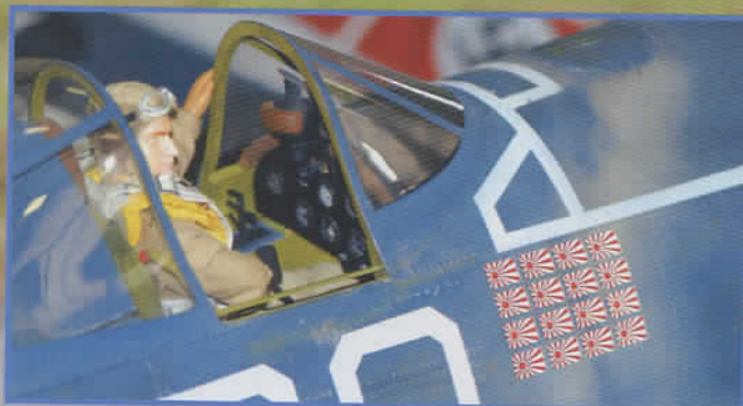
Le poste de pilotage en gros plan. Notez que la verrière coulisse. Commandée par radio, elle permet de décoller en position ouverte, puis de la refermer ensuite, comme à l'époque sur les porte-avions.
