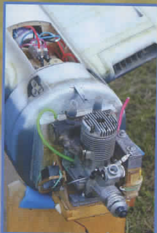
Le Moki 30 cc monté en position inversée. Le moteur idéal pour cet avion ?
