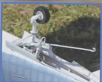
La roulette de queue rétractable est un exemple du genre
