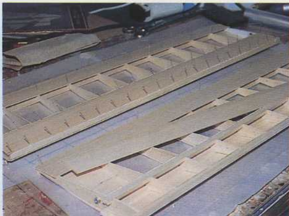
28) Après avoir retourné les panneaux d'aile, coffrer les parties situées à l'intrados.
