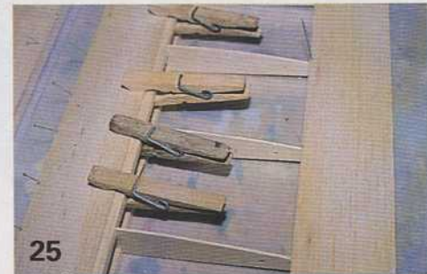
21) Fixer le longeron d'intrados sur le plan puis coller les nervures. Une cale de 5 mm sera placée sous le bord de fuite pour un maintien correct des nervures.
