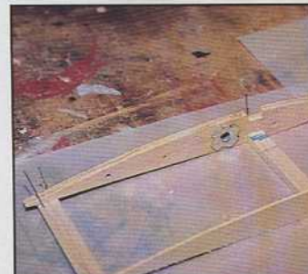
22) Collage de la nervure n°3 en contre-plaqué de 5 mm. L'écrou à griffes M6 pour la fixation de la dérive est déjà en place.
