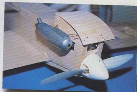
19) Réalisation de la partie inférieure du capot (en bois).
