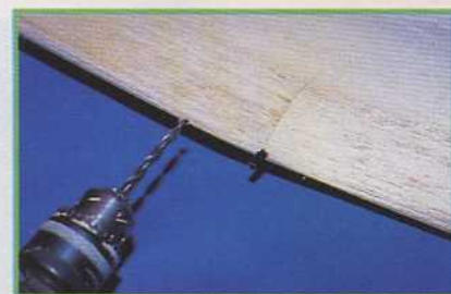
35) Percer le logement du tourillon de fixation de l'aile puis coller ce dernier. Il reste alors à poser un renfort en tissu plus résine époxy sur la partie centrale de l'aile (détail sur le plan).
