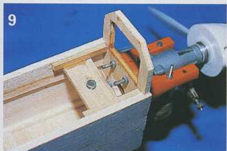
9) Collage de 2 baguettes 5x5 en pin pour renforcer la pièce de fixation de l'aile. L'écrou à griffes M6 est déjà en place.
