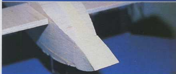
13) Collage de la pointe avant : bloc de balsa ou mousse de polyuréthane.
