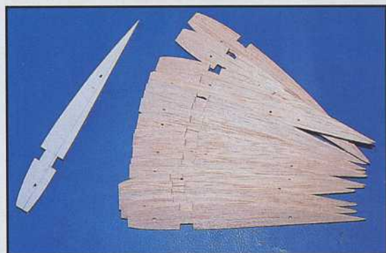
20) Découpe des nervures (méthode du bloc).
