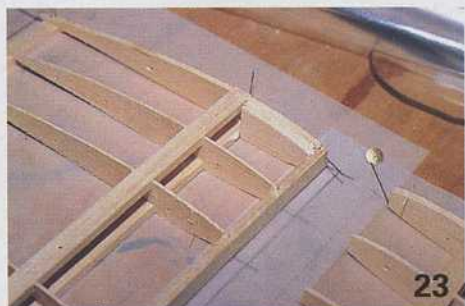
23) Collage de la nervure d'implantation n°1 et pose du renfort en balsa de 10 mm pour le logement du tourillon. 24) Coller le longeron supérieur et le faux bord d'attaque. Après séchage complet, raboter le faux bord d'attaque pour suivre le profil des nervures.
