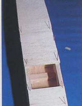
14) Coffrage du dessous et du dessus du fuselage. On laissera libre les accès aux éléments de la télécommande (bouchés ensuite par des trappes en balsa de 3 mm).
