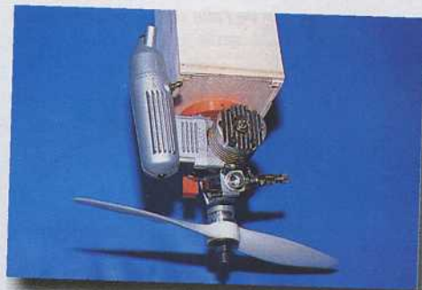
17) Mise en place du bâti moteur.
