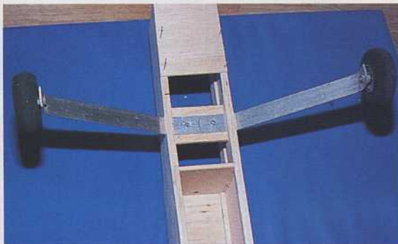
15) Présentation des deux demi-jambes du train d'atterrissage sur le fuselage. Elles seront fixées par une vis acier M3.
