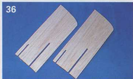
36) Découper les deux demi-stabilisateurs du plan canard (fibres dans le sens longitudinal de la pièce).
