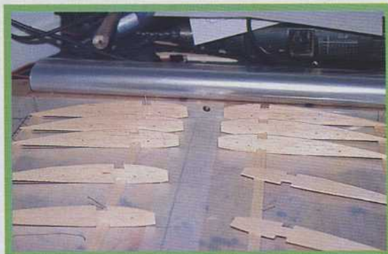
21) Fixer le longeron d'intrados sur le plan puis coller les nervures. Une cale de 5 mm sera placée sous le bord de fuite pour un maintien correct des nervures.
