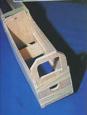
6) Assemblage des flancs à l'aide des couples n°1, 2, 4, 5 et 7.
