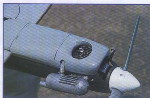
Le capot est taillé dans des blocs balsa et enveloppe le moteur de très près.
