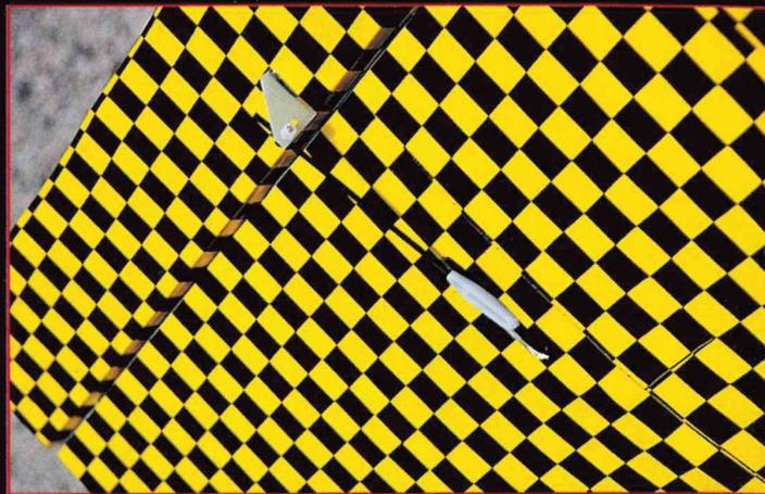
**Les servos d'ailerons totalement encastrés ne laissent voir que la commande directe.**
