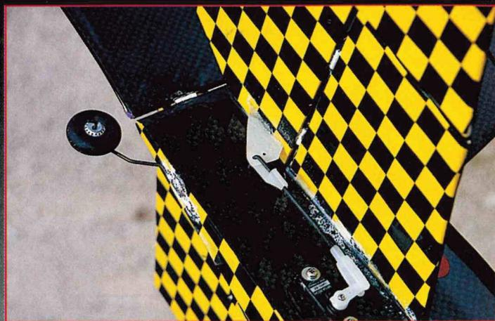
**Le servo de profondeur est logé comme sur les 3D « classiques », sous le stab. Commande directe et précise.**
