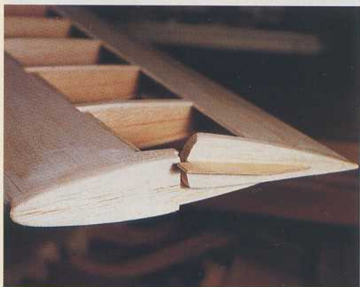
Détail du petit saumon en regard du compensateur aérodynamique solidaire de l'aileron.
