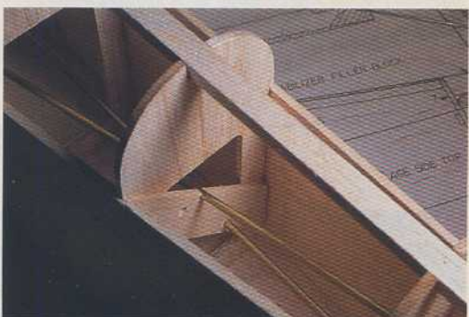
Pour immobiliser les gaines dans le fuselage, une simple baguette collée en travers sur laquelle les gaines sont elles-mêmes collées.
