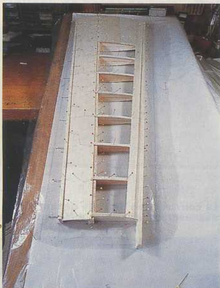
Coffrage partiel de l'extrados : tiers avant, centre et bord de fuite.
