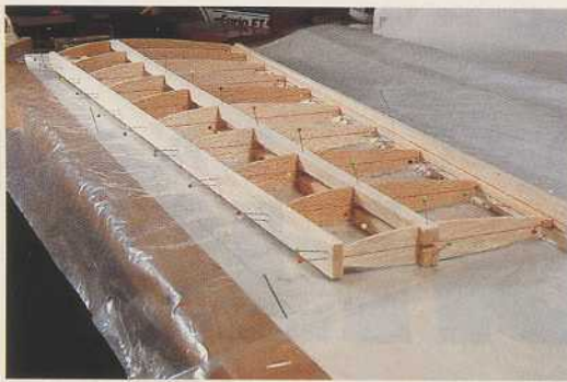
La structure de l'aile vue sous un autre angle : notez la précision qu'apporte le système des médiatrices tracées sur chaque pièce.
