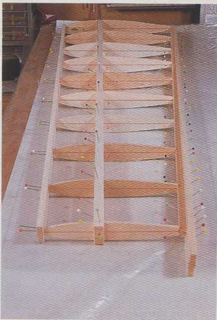
Mise en place et collage des nervures, longerons, bords d'attaque et de fuite.
