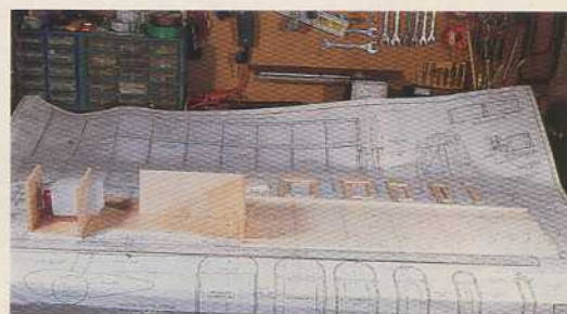
Le montage du fuselage commence par le collage des couples avant. Notez l'astuce du traçage de l'emplacement des couples sur l'intérieur des flancs mis bord à bord pour une parfaite symétrie.
