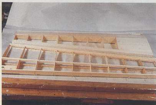
Vue des demi-ailes, l'une terminée, l'autre en cours de montage.
