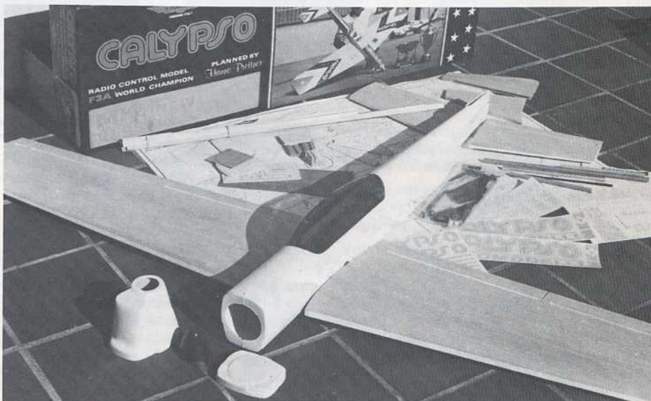
Le bâti-moteur universel conçu par Aviomodelli et les éléments du kit.
