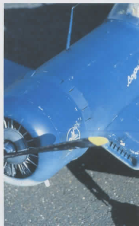
Souci du détail : les volets de capot sont mobiles comme ceux de l'avion grandeur.
