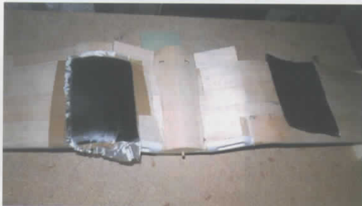
Les trappes de train sont moulées sur l'intrados de l'aile avant découpe des logements de train.
