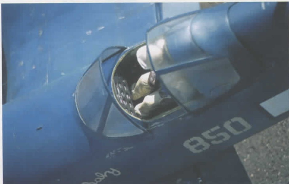
La verrière coulissante, sur rail, s'ouvre et se ferme manuellement.
