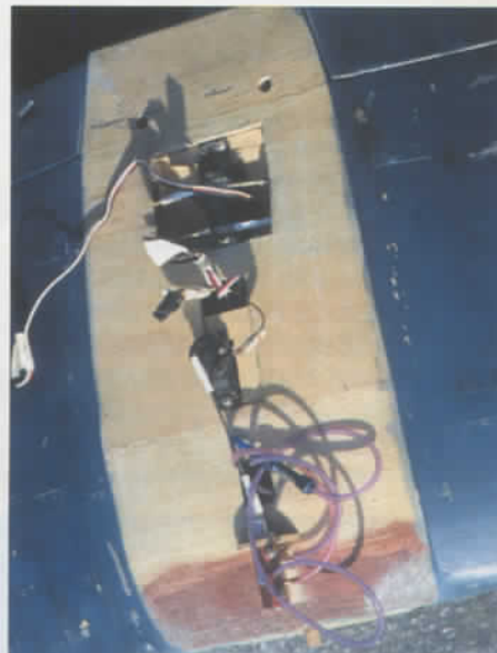
L'ensemble de commande pneumatique du train rentrant.
