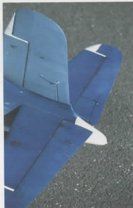
Pour une finition réaliste, de fines bandelettes de papier kraft simulent la marque des nervures sous l'entoilage.
