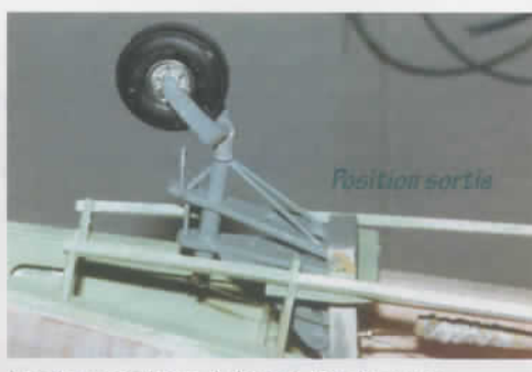
Les deux positions de la roulette de queue.
