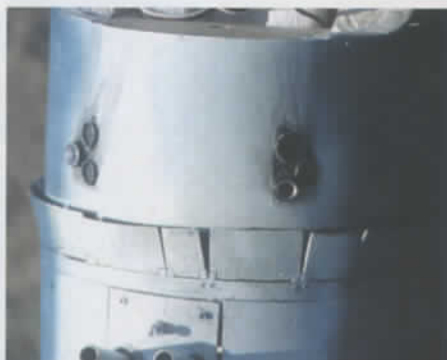
Le remplissage de la bonbonne d'air se fait via une prise dissimulée dans une pipe d'échappement.
