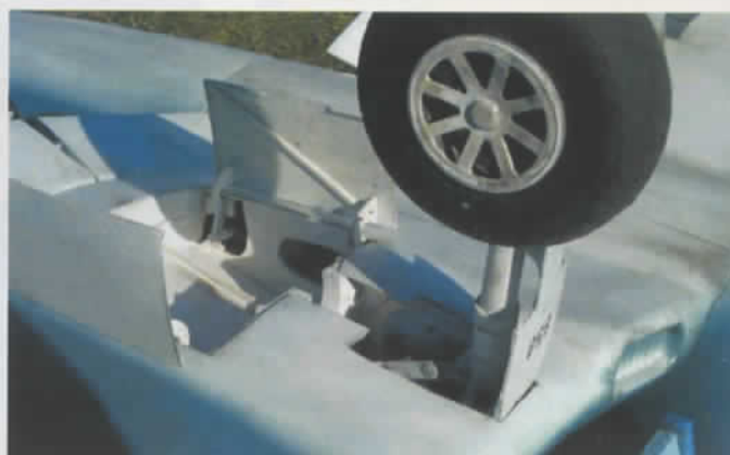
L'aménagement des logements de train. À remarquer les commandes de trappes.
