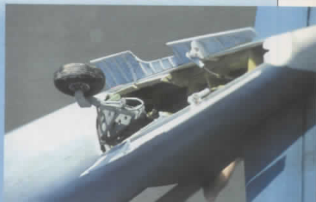
La roulette de queue fort bien réalisée en C.t.p. (À noter les commandes de fermeture des trappes)
