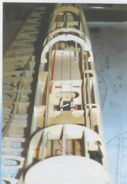
Le fuselage en cours de construction. À noter le servo de roulette de queue escamotable situé derrière le couple moteur.
