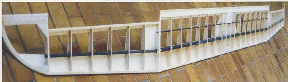
Vue de l'ensemble de l'aile intrados, montage du longeron en tube de carbone.
