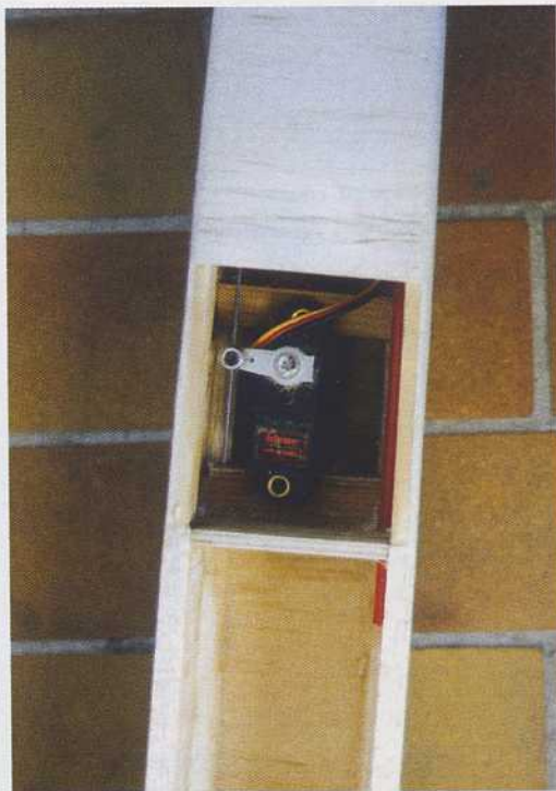
Vue de dessous, puits du servo de profondeur.
