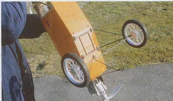
Le train d'atterrissage comporte également une béquille avant, juste pour le folklore ! A noter les deux vis dépassant sous le fuselage, destinées à l'attache des haubans
