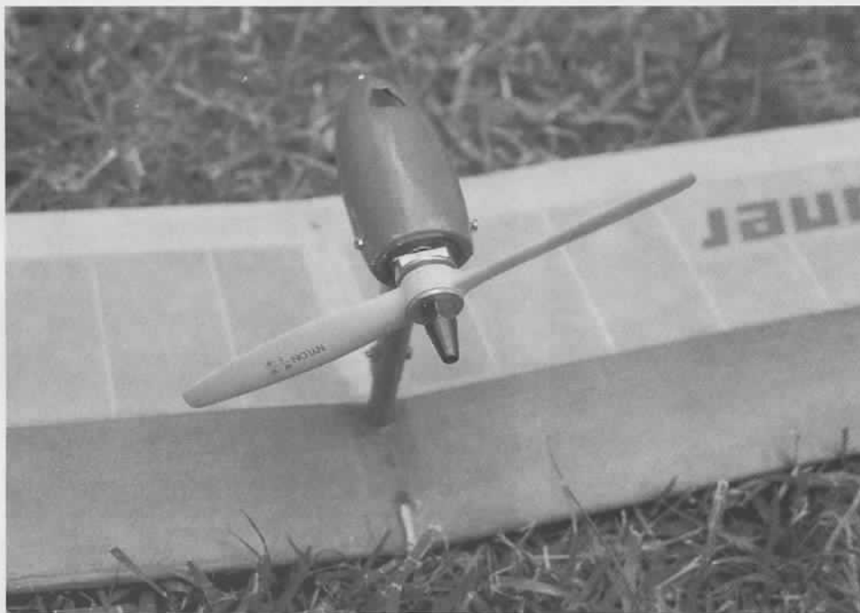
Le pylône moteur solidaire de l'aile.
