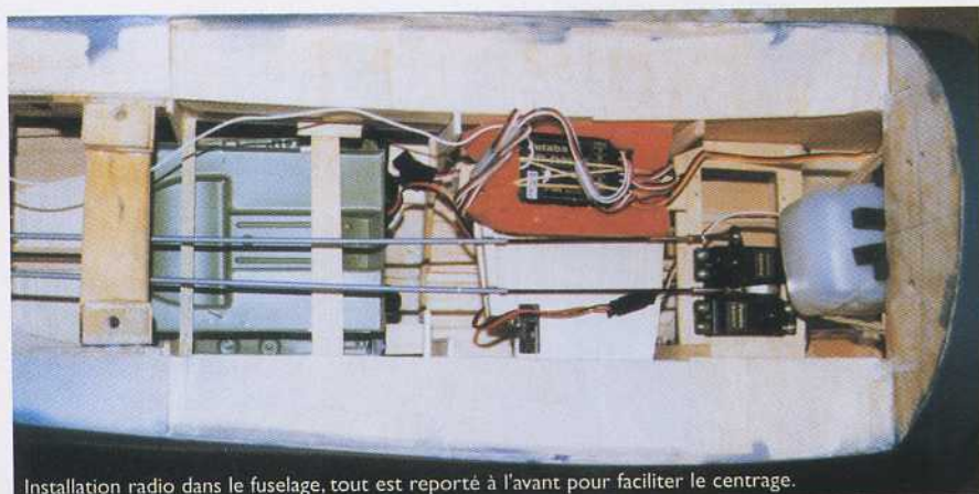
Installation radio dans le fuselage, tout est reporté à l'avant pour faciliter le centrage.
