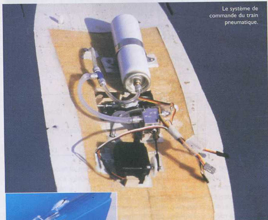
Installation radio dans le fuselage, tout est reporté à l'avant pour faciliter le centrage.
