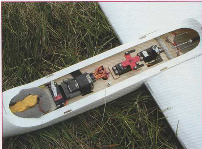
La grande verrière enlevée, on découvre une installation radio toute en longueur.
