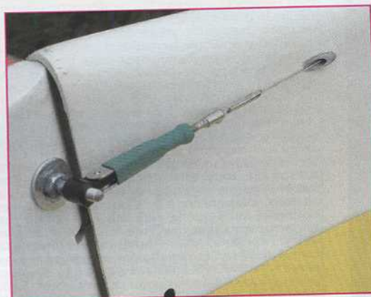
La commande de dérive, faite par câbles aller/retour, en acier gainé.
