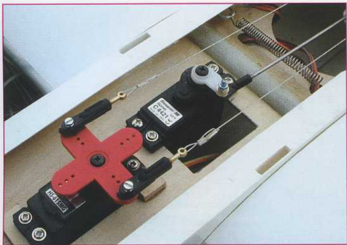
Gros plan sur les servos de profondeur et de dérive, solidement fixés sur la platine posée par le fabricant.
