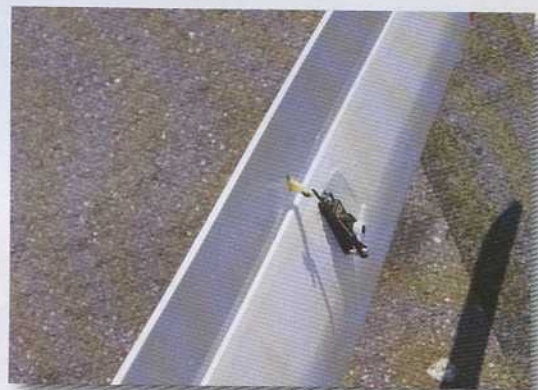
Les servos d'ailerons ont été installés verticaux pour ne pas avoir à modifier la structure des ouvertures.
