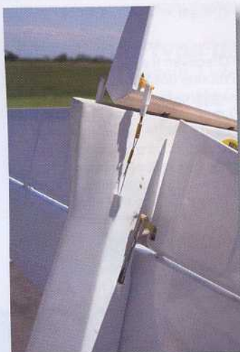
Commande aller-retour pour la dérive, et modifiée rigide pour plus de précision par l'auteur pour la profondeur.
