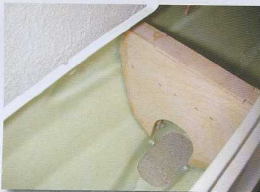
Fourreau de clé d'aile et couple «costaud» sont installés d'origine. Dommage que la fixation du train ne soit pas reprise également.
