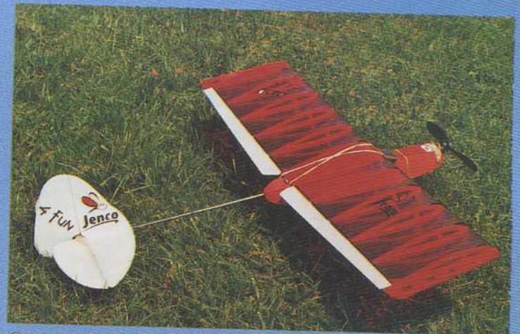
On voit bien ici les nervures à profil biconvexe de la version 3 axes.
