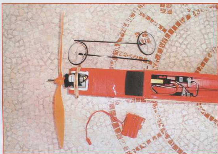
Le même, équipé cette fois en "indoor" : moteur GWS, train carbone à roues ultra light, accu mini.
