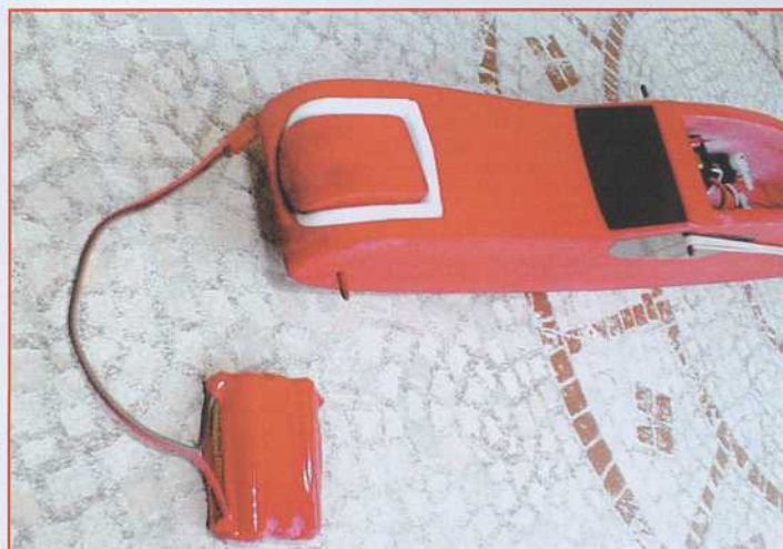
Et pour finir, la version planeur, avec un accu de 250 mAh et plus de train nin de moteur.
