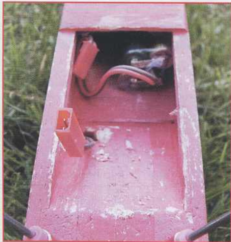
L'accu se loge dans un bac qui l'éjecte en cas de choc.
