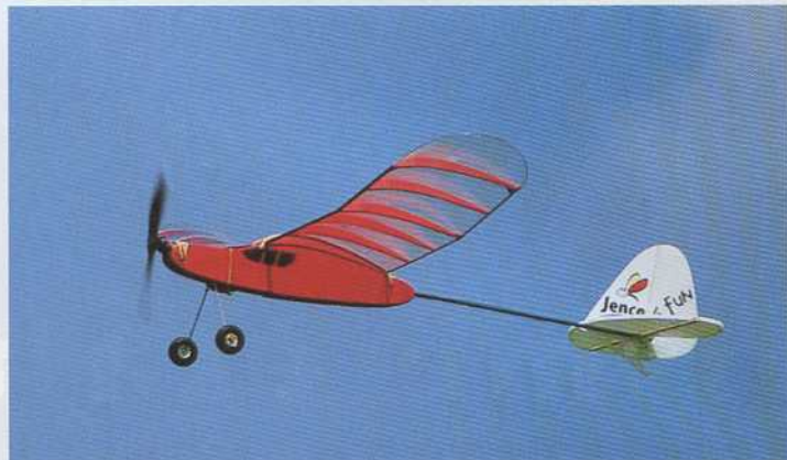
La silhouette du 4 Fun se reconnaîtra facilement, avec sa poutre arrière et ses empennages en Dépron découpé dans un style Piper Cub.
