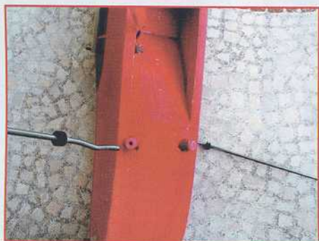
Les trains sont enfichés dans des puits en durit souple.
